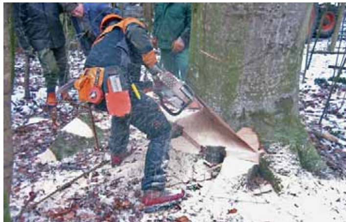
Das genaue Schneiden des Fallkerbes ist sehr wichtig beim Fällen von Bäumen.
